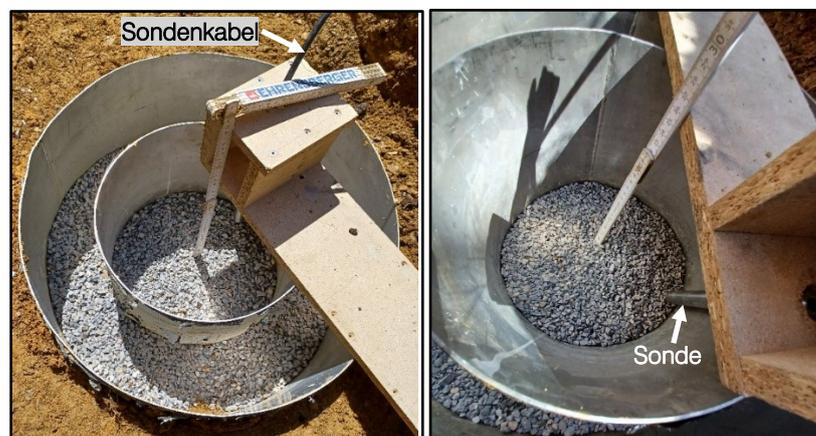
Abbildung 11: Versuchsaufbau mit Doppelringinfiltrometer, Druckmesssonde und Kiesschicht
